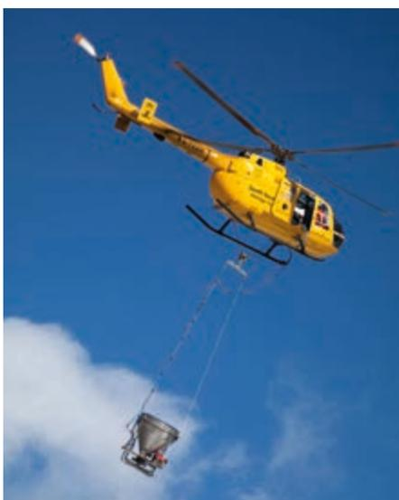
Die Köder werden mit dem Hubschrauber an den entsprechenden Abwurfort geflogen und dort flächendeckend verteilt („aerial broadcasting“).
