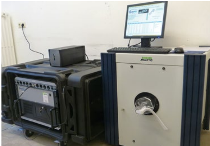
Abb. 1: QMR-Gerät EchoMRI® (Zinsser Analytic GmbH, Frankfurt am Main), bestehend aus dem Messgerät (rechts) und dem Rechner (links). Foto: F. Bairlein
