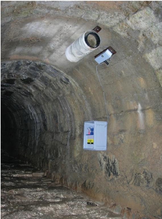
Abb. 1: Neststandort der Wasseramsel in einem Bachdurchlass mit betriebsbereiter Transponderanlage. Oben die Neströhre mit der schwarzen Empfangsantenne am Eingang. Rechts oben der Datenlogger und unten der geöffnete Batteriekasten. – *Arrangement of Dipper's nestbox, logger and current supply.*
